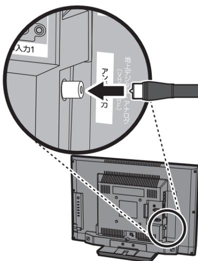
②壁面アンテナ端子とアンテナ線を接続する
