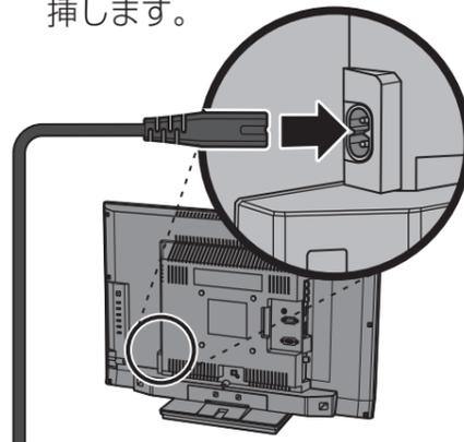
②電源ケーブルをコンセントに挿します。
